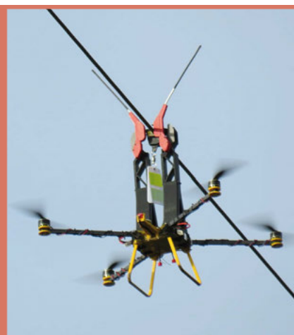
De drone, die bestuurd werd door een piloot in het veld, klemt de markeringen aan de kabel.
