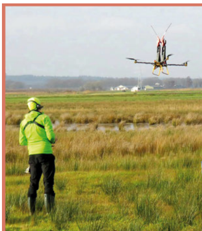
De drone, die bestuurd werd door een piloot in het veld, klemt de markeringen aan de kabel.
