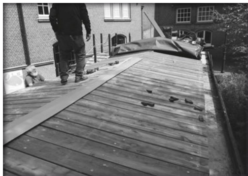
De timmer- en staallieden op het binnenplein van het Veenkoloniaal Museum, bezig met het aanbrengen van luiken en merkers op de Eben-Haëzer.
